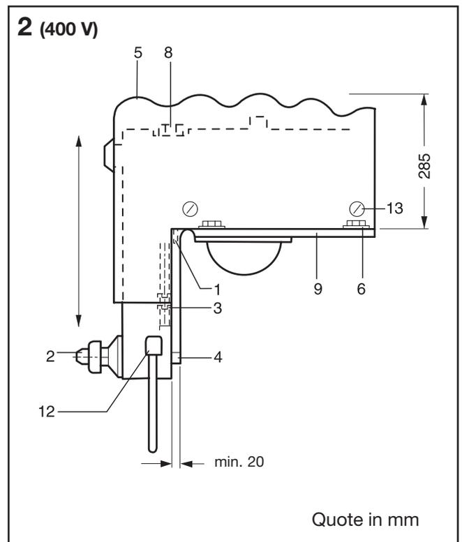
Svitare le viti di chiusura (8). Riempite lentamente d'acqua lo spazio della pompa.
