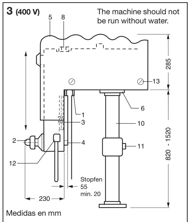
Afloje en el pie de apoyo (10) el perno de fijación (11) y despliegue el pie de apoyo hasta que este se encuentre totalmente sobre el piso cuando el equipo esté en posición horizontal.
