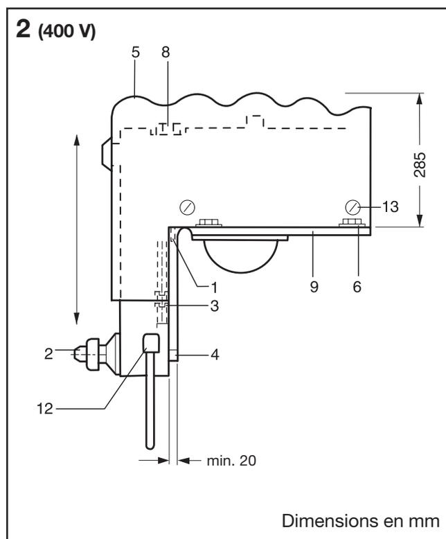
Visser la vis de fermeture (8). Remplir lentement la chambre de la pompe avec de l'eau.
