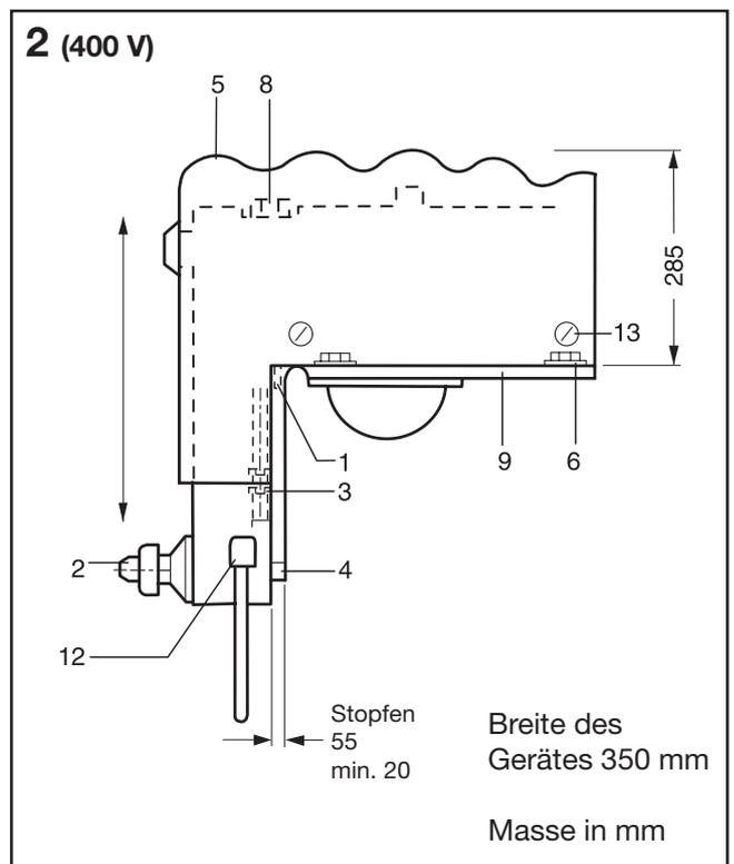
Reissen Sie die 4 Befestigungslöcher, die jetzt zugänglich sind und sich am Aussenrand der Bodenplatte (6) befinden, an. Schrauben Sie das Gerät mit den Schrauben M 8 x 60 fest.
