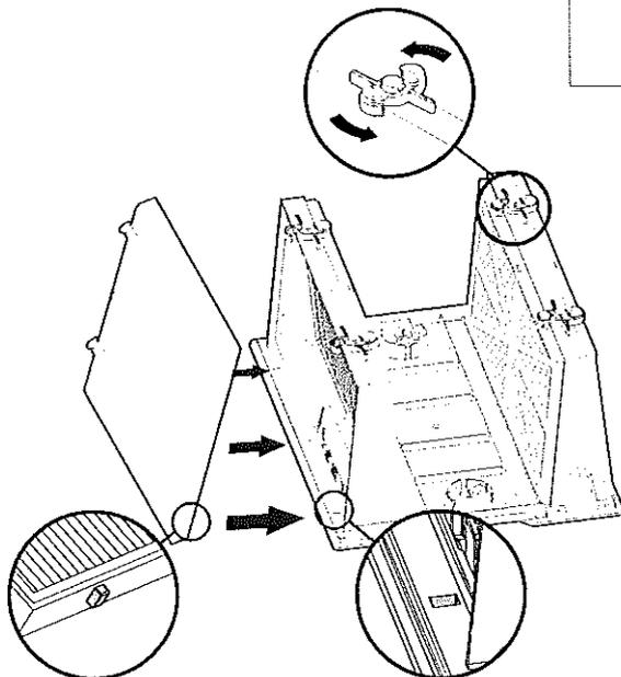
Setzen Sie den Filter ein, wobei die Plastikverstärkung nach außen schaut.
