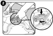
Ändern Sie den Griff Position diagonal. Dies bestimmt die Geschwindigkeit, mit der der Roboter sich entlang der Wasserlinie.
